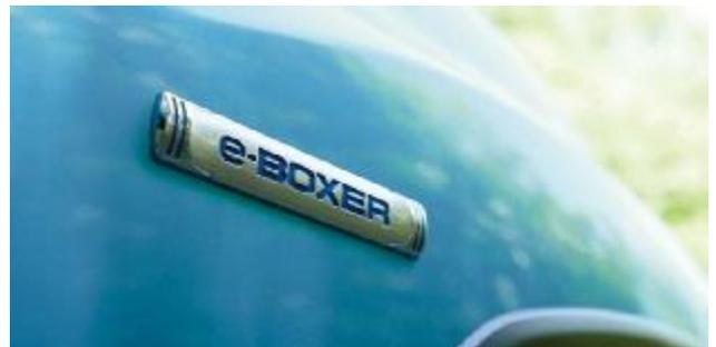
※e-BOXER とは、水平対向エンジンと電動技術を組み合わせた新開発のパワーユニット効率を高めた水平対向エンジンに、コンパクトで高性能なモーターとバッテリーをシンメトリカル AWD レイアウトに統合
